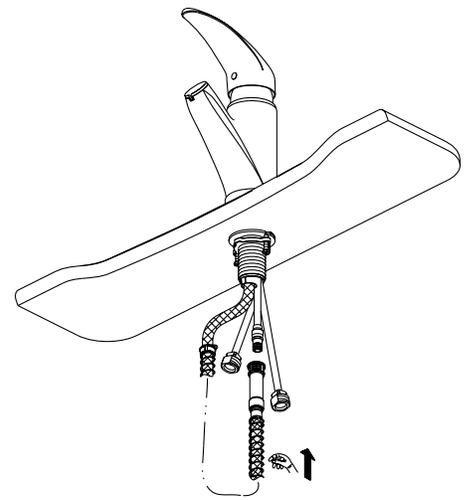
Instale el conjunto de la manguera de conexión rápida, para instalar los empalmes rápidos, siga estas indicaciones:
